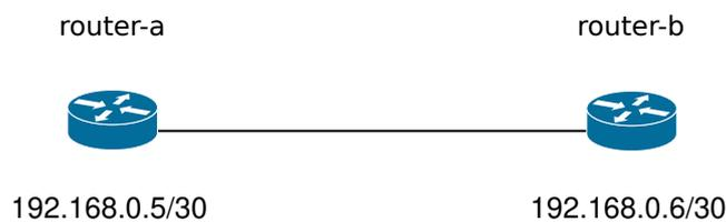
FIGURE 6 – Exercice 1 - Schéma de l'architecture réseau.
